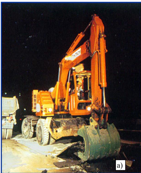
1.4 Сурет – Жабынды бұзушылар – асфальтты-бетонды жабындарды қопару үшін және цементті - бетонды жоғары бетін бетанол мен бұзуға арналған қарапайым аспалы жабдықтар
