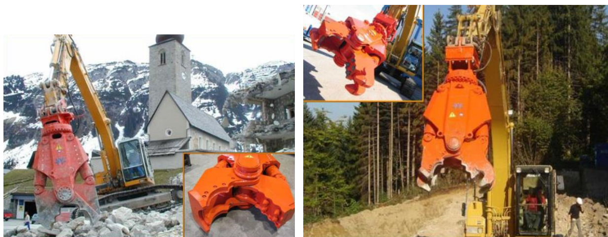
1.15 Сурет – жер бетіндегі темір-бетондарды ұсақтау үшін қолданылатын гидроқайшылар
