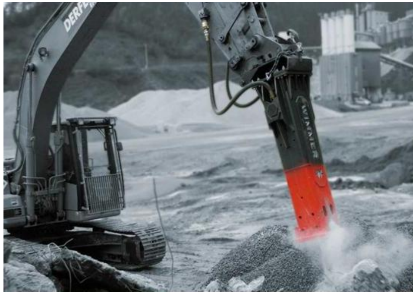
1.7 Сурет – Материалдарды үгітуді орындайтын гидробалғалар
