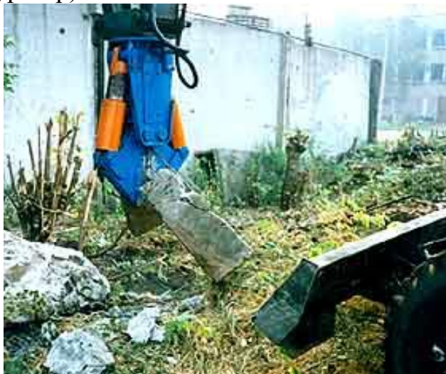
1.13 Сурет – Неғұрлым ыңғайлы жұмыс үшін, оңтайлы бағыттағы ұсақталғыштық құрылыс материалдарын орнату мақсатымен гидроқайшының айналмалы құрылғысын қолдану
