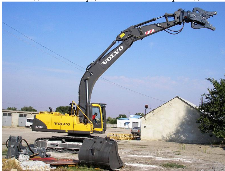
1.21 Сурет – экскаватордың қауғасына орнатылған гидроқайшылар және ауыспалы жабдықтың жинағы бар экскаватор
