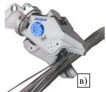
1.10 Сурет – темір бөренелерді кесуге (а) бетон блоктарды қиратуға(б) және арматураны кесуге мүмкіндік (в) беретін гидроқайшының әртүрлі орындалуы
