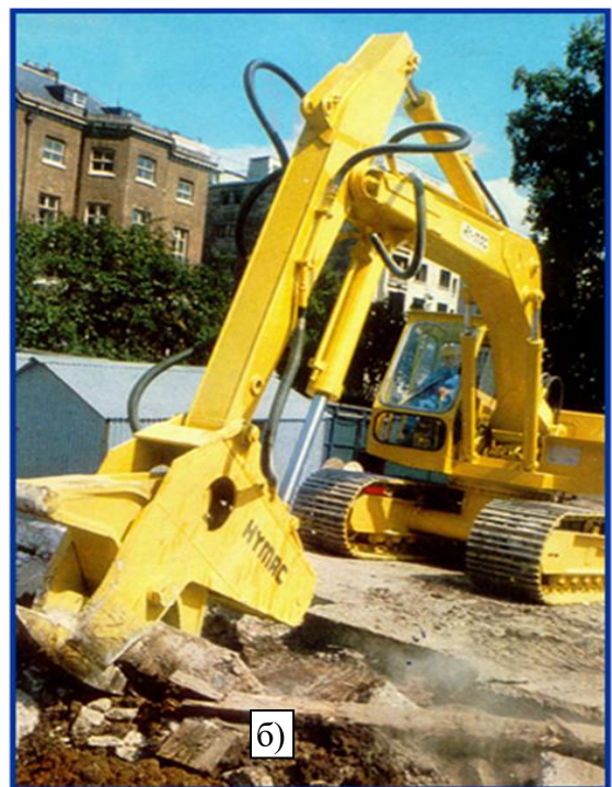
1.4 Сурет – Жабынды бұзушылар – асфальтты-бетонды жабындарды қопару үшін және цементті - бетонды жоғары бетін бетанол мен бұзуға арналған қарапайым аспалы жабдықтар
