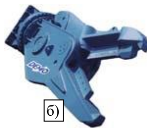
1.10 Сурет – темір бөренелерді кесуге (а) бетон блоктарды қиратуға(б) және арматураны кесуге мүмкіндік (в) беретін гидроқайшының әртүрлі орындалуы
