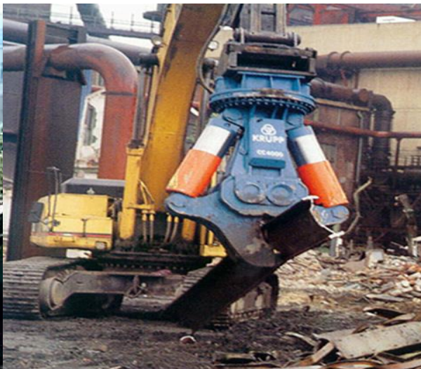
1.13 Сурет – Неғұрлым ыңғайлы жұмыс үшін, оңтайлы бағыттағы ұсақталғыштық құрылыс материалдарын орнату мақсатымен гидроқайшының айналмалы құрылғысын қолдану
