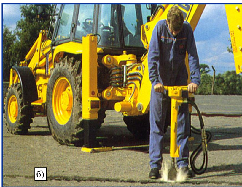
1.1 Сурет – Шар-бабының көмегімен барысында ғимараттарды қирату(а) және экскаваторлық гидрожүйесіне қосылған гидравликалық құралдың жұмысы (б)
